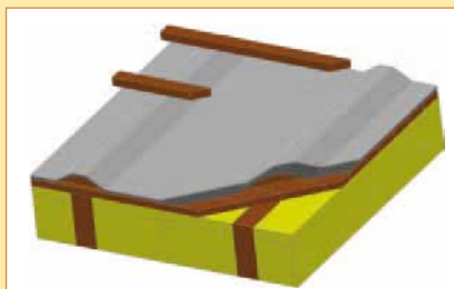
Na bedněni - zateplené podkroví.
