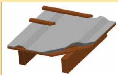
Na bedněni - nezateplené podkroví.
