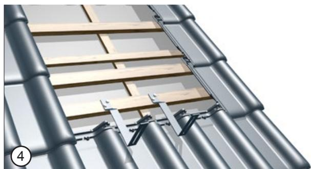
Kolejnym etapem jest przykręcenie dolnego elementu dwuczęściowego wspornika (typ DB/DC) do wcześniej zamontowanej dolnej łaty montażowej (za pomocą wkrętów z łbem sześciokątnym).
