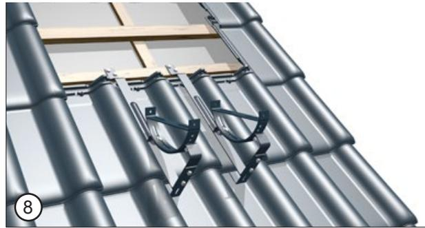
Na wsporniku należy ułożyć i wypoziomować mocownik ławy kominiarskiej. Oba elementy należy ze sobą skrócić za pomocą załączonych do zestawu śrub – 2 szt./wspornik).
