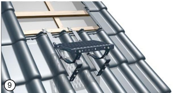
Po zamocowaniu drugiego wspornika z mocownikiem (za pomocą załączonych śrub) należy przykręcić ławę kominiarską. Następnie należy sprawdzić poprawność wykonanego montażu, w szczególności należy sprawdzić stabilność wszystkich połączeń mechanicznych.
