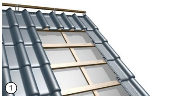
Prace należy rozpocząć od demontażu części dachówek – występujących w miejscu planowanego umieszczenia komunikacji dachowej.
