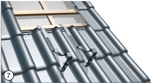
Po ułożeniu kolejnego rzędu dachówek, w analogiczny sposób należy zamontować drugi element dwuczęściowego wspornika DB/DC.
